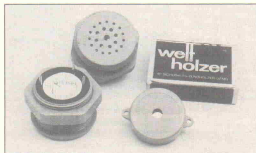
Bild 10. Piezoschallwandler mit im Gehäuse integrierter Elektronik. Bei dem Modell links vorne dient der dritte Stift zur Erzeugung eines Intervalltons.
