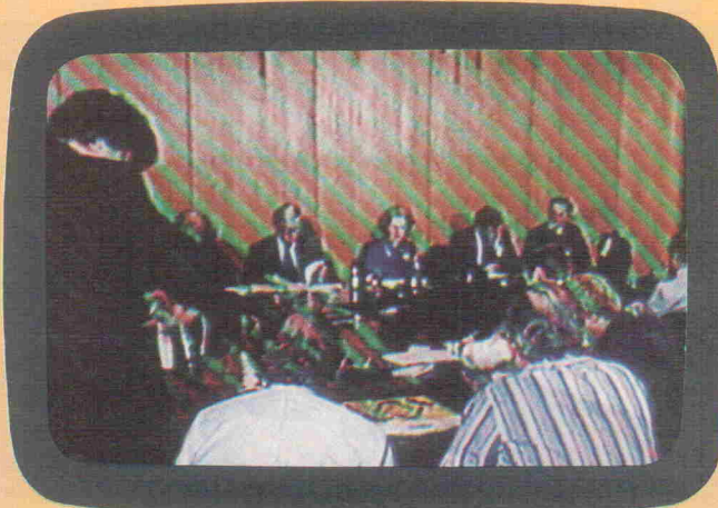
Bild 12. Typische Störung des Fernsehbildes durch einen Sender mit gleicher Frequenz (Gleichkanalstörung).
