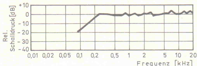
Bild 12. Übertragungskennlinie eines Miniaturlautsprechers. Belastbarkeit 0,1 W, Impedanz 32 \Omega , Maße 27 mm \varnothing x 11 mm (nach Monacor).
